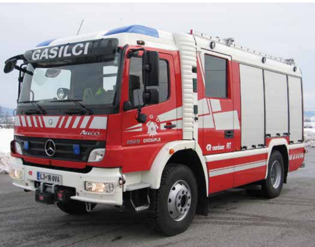
GVC-16/25, 1+5 Mercedes Atego 4x4, gasilsko vozilo s cisterno.
