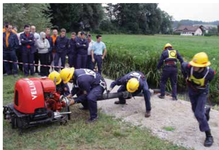
2010: Velikomlačevski člani pri pripenjanju sesalnega voda na motorno brizgalno.
